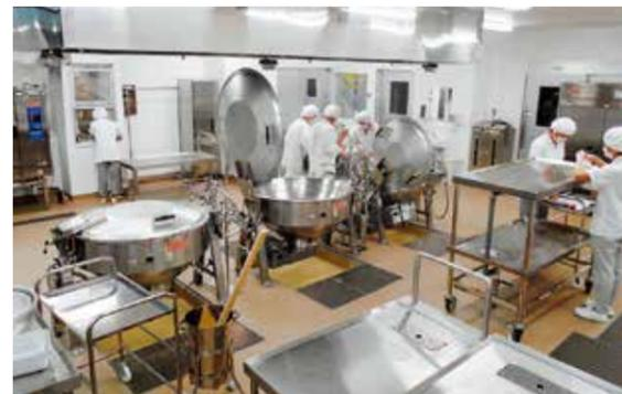
ドライシステムを導入し、場内を汚染区域と非汚染区域に分け、検収、下処理、調理、配膳など各部屋単位で分離しています。食材の納品から配送まで一方通行で移動させるつくりとし、人や食材による交差汚染が発生しない動線としています。
