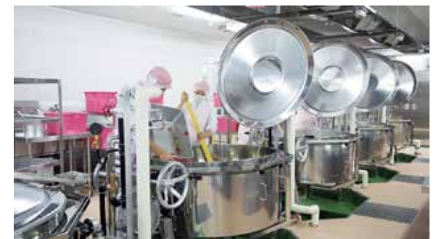
800リットルの蒸気釜6基により、汁物、煮物、炒め物など約3,000食の温食が調理されます。
